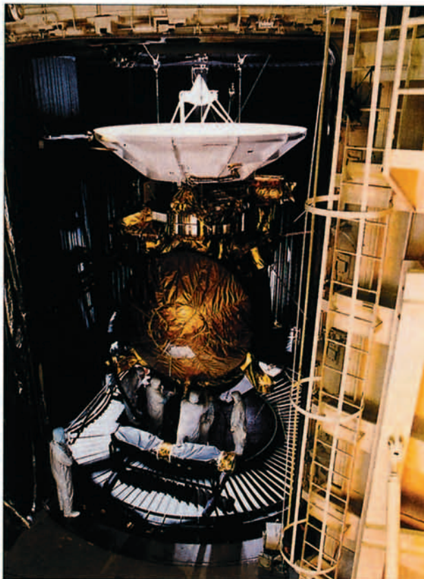
La sonda Huygens durante el proceso de instalación en la nave Cassini.
