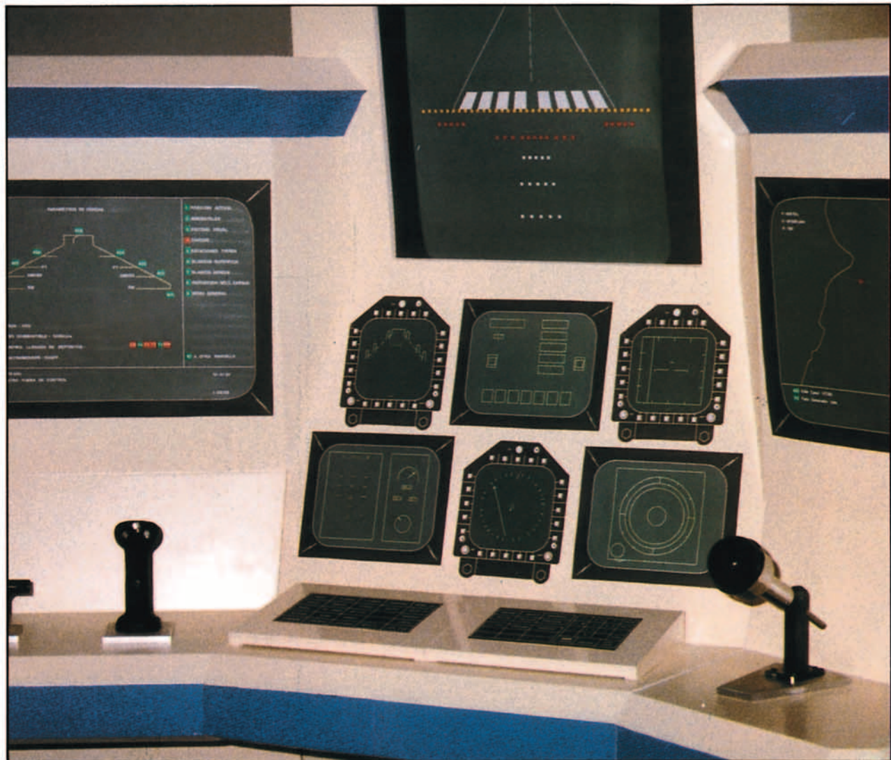
Puesto de monitor de un simulador para EF-18 desarrollado por CESELSA.
