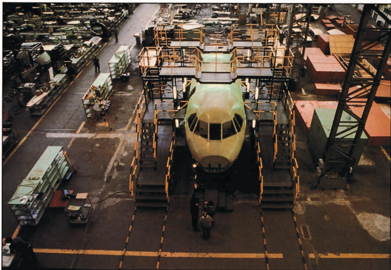
Fabricación del fuselaje del CN.235.
