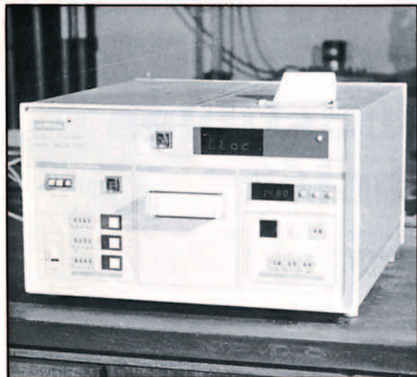
Azufre en productos petrolíferos, por fluorescencia de Rayos X. INTA 15 06 21.
