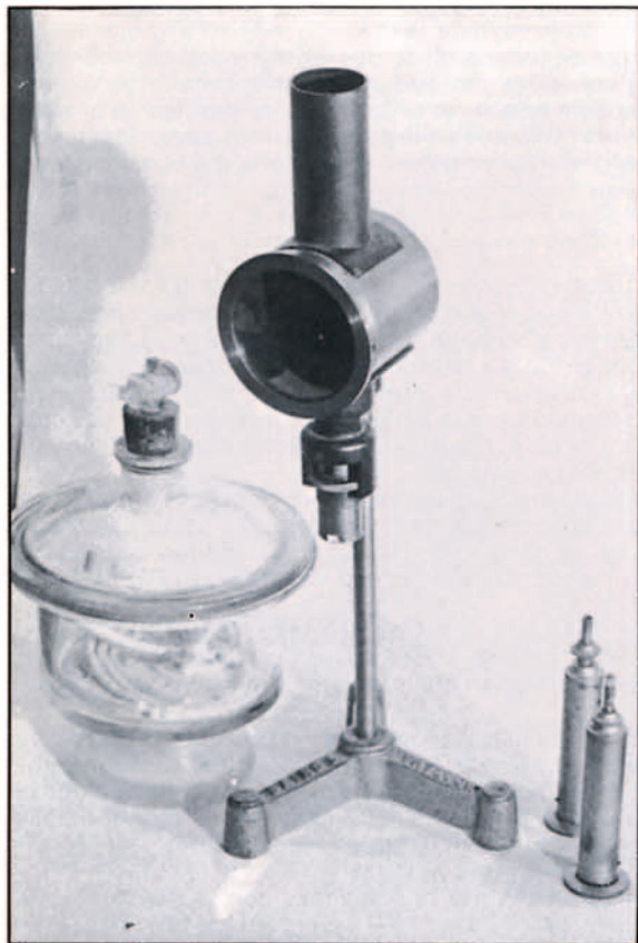
Punto de humo de combustibles para motores de turbina. INTA 15 06 14B.
