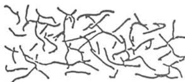
**D.M.C. O PREMIX:** PASTA FORMADA POR UNA COMBINACIÓN DE RESINAS, REFUERZOS DE F. CORTADAS Y DETERMINADOS COMPUESTOS QUIMICOS AUXILIARES.
