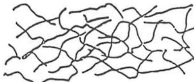
**S.M.C. "SHEET MOLDING COMPOUND":** LAMINAS FORMADAS POR FIBRAS CORTADAS QUE VARIAN DESDE 6,35 A 50 mm. DE LONGITUD Y CARGAS IMPREGNADAS EN RESINA.
