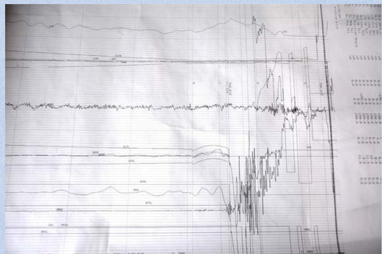
Parte de un registro conjunto de LOC y GS, de un ILS
