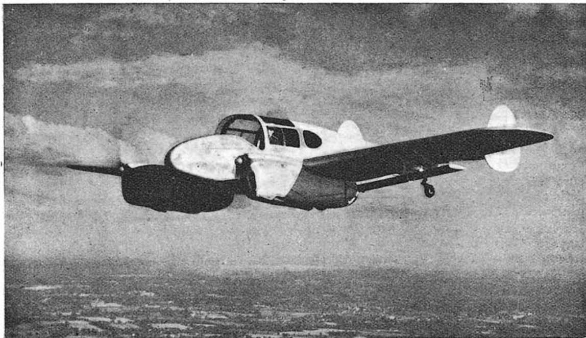
Bimotor cuatriplaza de tren retractil y motores Cirrus de 100 cv. Velocidad comercial, 210 kilómetros/hora. Radio de acción práctico, 1.200 kms.
