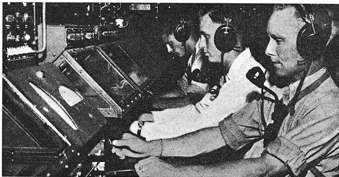
Operadores de una estación GCA. En primer término el indicador de distancia; en segundo el de azimut, y el tercero el que transmite las indicaciones al avión.
