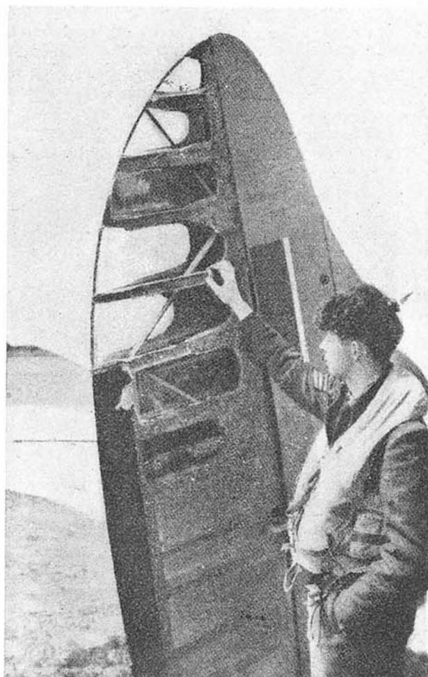
Destrozos causados en la cola de un avión de caza tipo "Tempest" por la explosión de una bomba volante.
