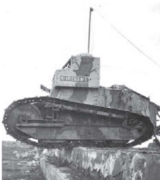
Carro de mando FT-17 TSH. Puede observarse que la torreta es reemplazada por una superestructura equipada con un equipo de comunicaciones. Fuente: Regimiento Acorazado «Alcázar de Toledo» núm. 61
