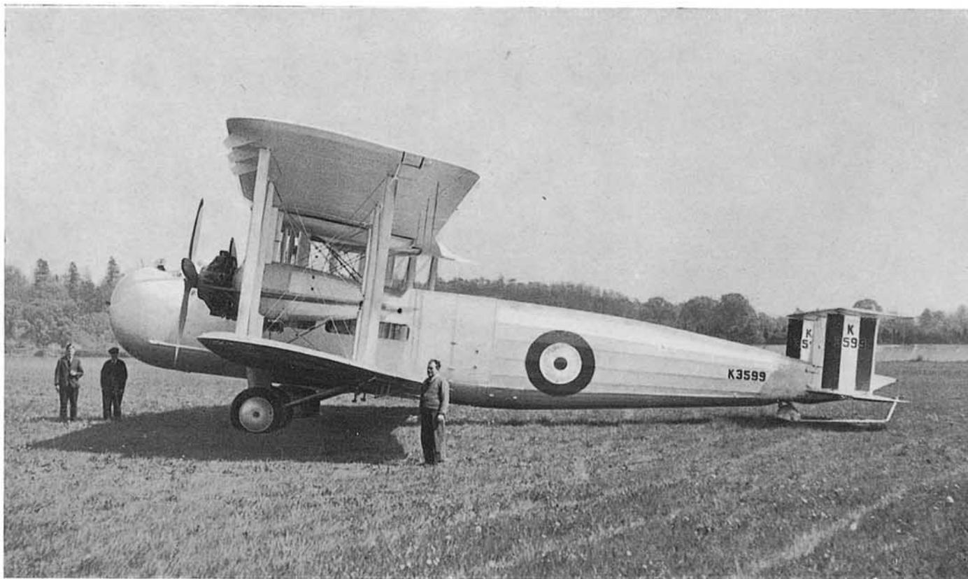
Una vista del avión de transporte de tropas Vickers «Valentia». Es una reciente derivación del antiguo tipo «Victoria», del cual se diferencia en que va provisto de dos motores Bristol «Pegasus» en lugar de dos Napier «Lion XI» y posee un tren de aterrizaje más perfeccionado. Puede transportar 22 hombres armados y dos de tripulación.
