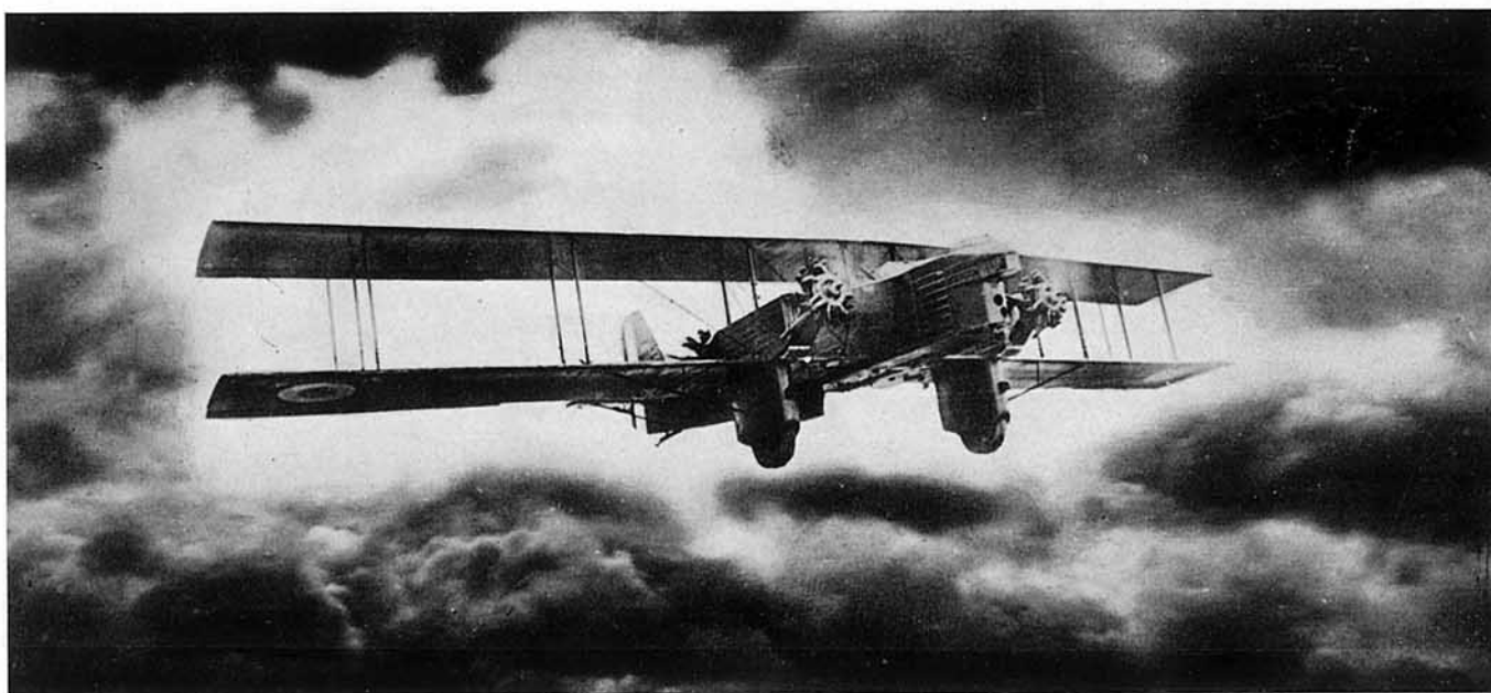
Una vista en vuelo del avión francés de bombardeo LeO 203 Lioré & Olivier , movido por cuatro motores Gnome-Rhône , «Titan» K-7, de 300 cv. Puede llevar una carga militar de 2.678 kilogramos, a una velocidad máxima de 215 kilómetros hora.
