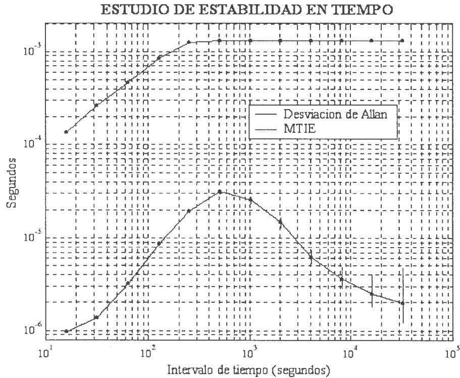
Figura 4. 4.- Estudio de la estabilidad en tiempo, presentando la desviación de Allan modificada y el error máximo en un intervalo de tiempo (MTIE).
