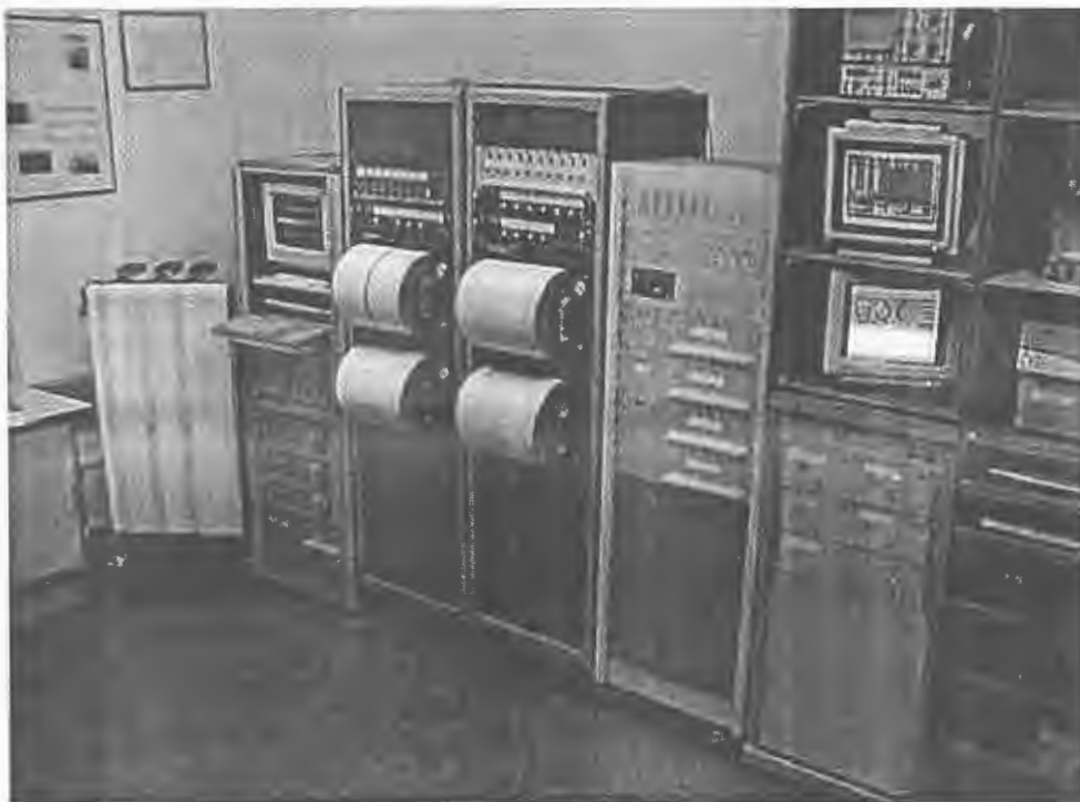
Figura 1. 7: Estación Central en la sala de Sismógrafos del Real Instituto y Observatorio de la Armada. Al fondo se aprecia el registro de las 3 componentes del sismógrafo de largo periodo Sprengnether. En el centro, los tambores de registro de la red de corto periodo (8 canales, 2 por tambor) y la electrónica asociada. A la derecha de la figura se aprecia el ordenador de adquisición implementado algoritmos de detección tipo STA/LTA.
