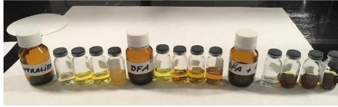
Figura 6. Muestras de Centralita, DFA, DFA + Centralita con sus respectivas muestras envejecidas a una, dos y cuatro semanas.
