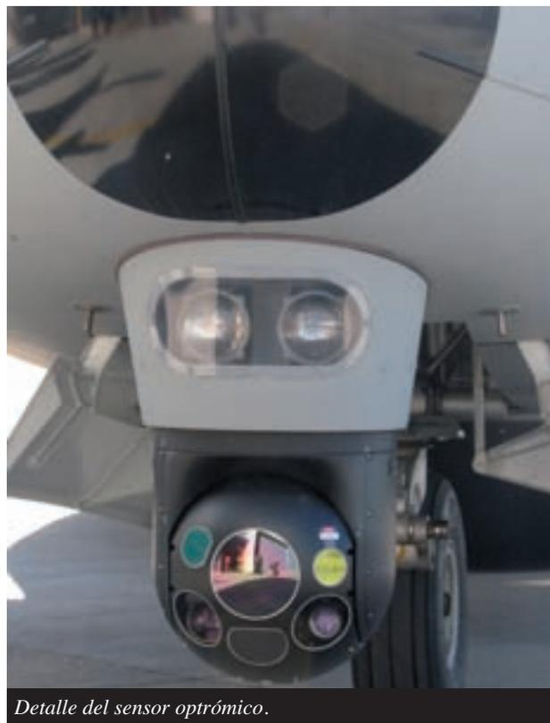
*Detalle del sensor óptico.*
