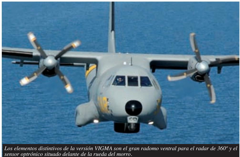
*Los elementos distintivos de la versión VIGMA son el gran radomo ventral para el radar de 360° y el sensor oprónico situado delante de la rueda del morro.*
