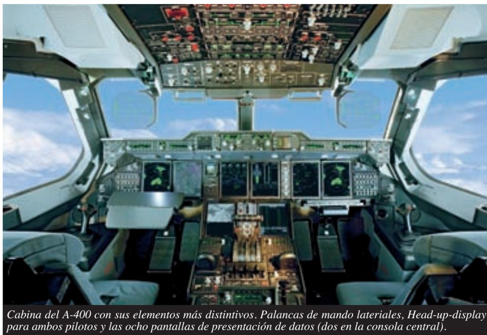
*Cabina del A-400 con sus elementos más distintivos. Palancas de mando laterales, Head-up-display para ambos pilotos y las ocho pantallas de presentación de datos (dos en la consola central).*
