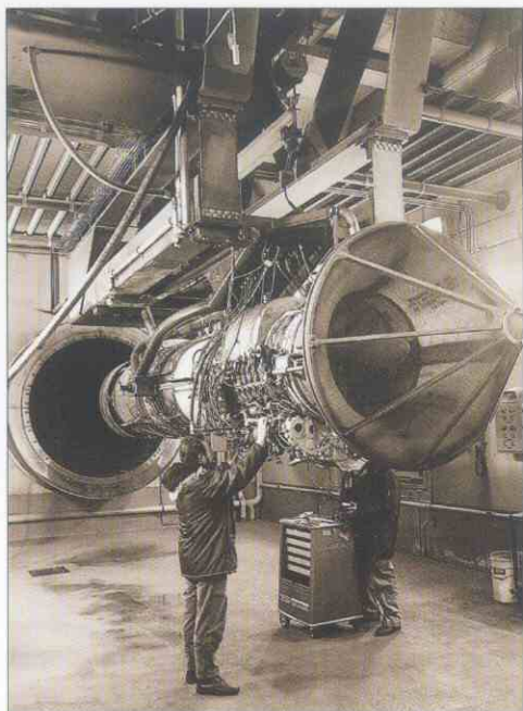
Turbojet Snecma Atar en rodaje en un banco de pruebas en la factoría de ITP en la localidad madrileña de Ajalvir.
