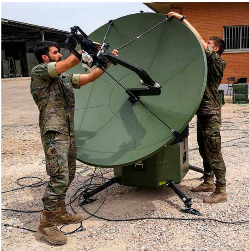
Ilustración 3: Montaje del TLB 50 IP en las jornadas de actualización de conocimiento satélite
