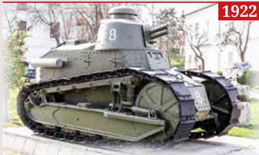
Renault FT-17 (Francia) Alcanza una velocidad de 7,8 km/h, con una autonomía de 80 km.
