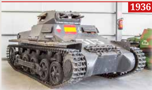
Panzer I B (Alemania) Su armamento consiste en dos ametralladoras de 7,92 mm.
