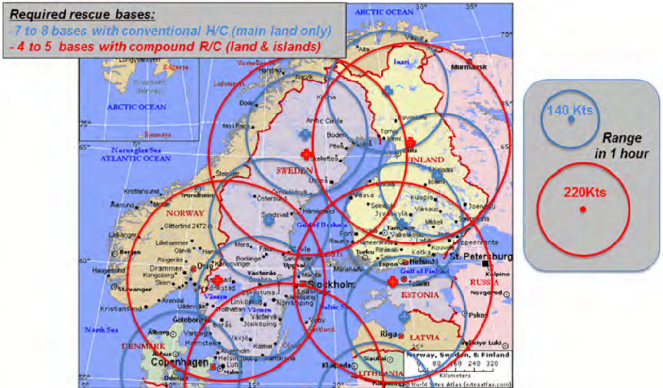
Fig. 4. Comparativa alcance helicóptero convencional vs helicóptero compuesto. (Fuente: AIRBUS Helicopters)
