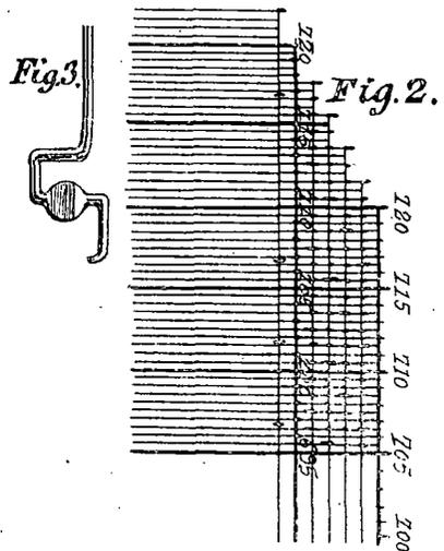
aire seco, podrían llegar á apreciarse décimas y aún fracciones más pequeñas de milímetro. La figura 3 indica la forma que debería darse al extremo del tubo para que toda la parte del mismo no ocupada por el aire se llenase de mercurio, en vez de tener sólo un índice de este metal: el diámetro de la bola debería ser de 12,6 milímetros.
