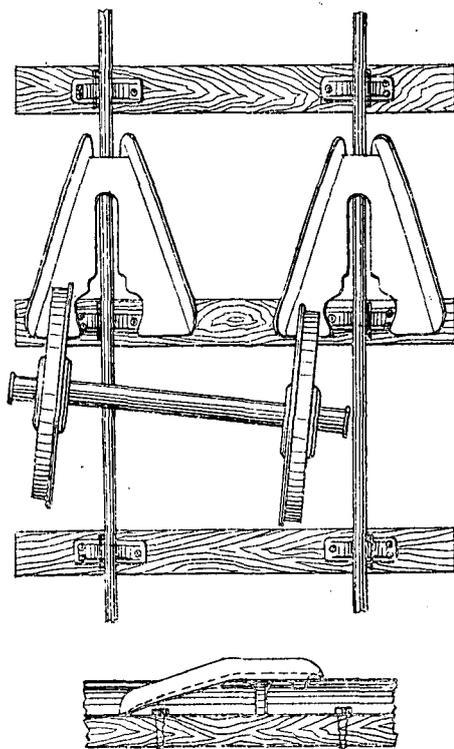
Existen placas de dos clases; una para los carriles *vignole*, y otra, que es la representada en la figura, para las vías construidas con carril de doble seta, montado sobre cojinetes, en las que únicamente varía la abertura por la que pasa el carril, cuya forma es la conveniente para que en ella pueda alojarse el cojinete.
