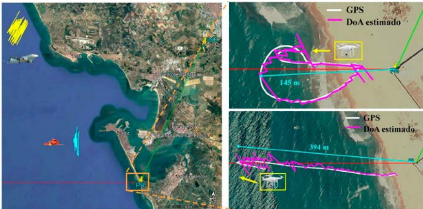
Fig. 6. Sistema IDEPAR desplegado en el centro de ensayos de Torregorda, Cádiz. Trayectorias estimadas (izda). Zoom de las trayectorias estimadas para el dron (dcha). (Fuente: propia).
