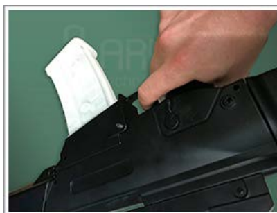
Fig. 9. Prototipo de sensor de disparo para diestros instalado en el fusil. (vista lado contrario) (Fuente: ARMEN Technology).
