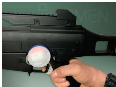
Fig. 8. Prototipo de sensor de disparo para diestros instalado en el fusil. (Fuente: ARMEN Technology).
