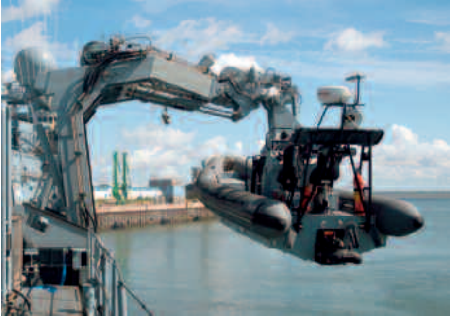
Grúa de costado.
