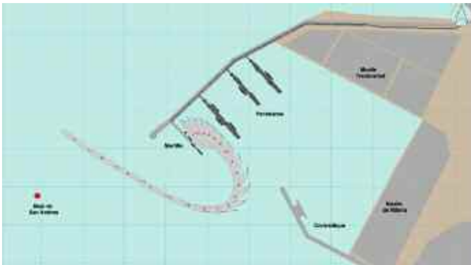
Figura 3. Maniobra de salida del buque VLCC en lastre desde la punta del Martillo (Langosteira) con viento del SW 25 nudos y olas de 4,5 metros.
