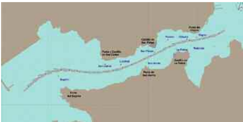
Figura 4. Maniobra de entrada de un crucero (viento del SW de 25 nudos y 3,9 metros de corriente media).
