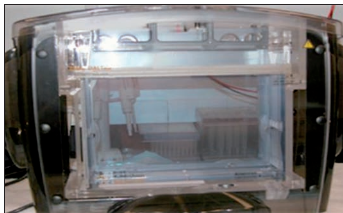
Figura 2. Dispositivo de electroforesis bidimensional, segunda dimensión.
