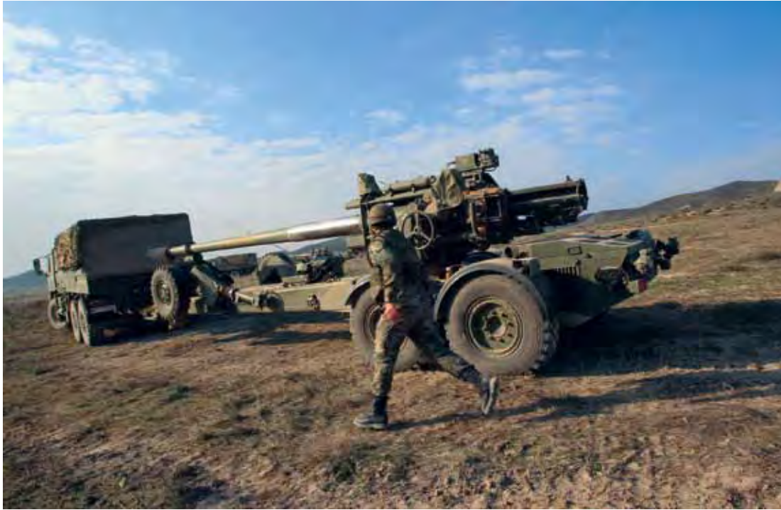
El apuntador del obús 155/52 puede fijar las coordenadas del objetivo también de manera manual con el goniómetro.
