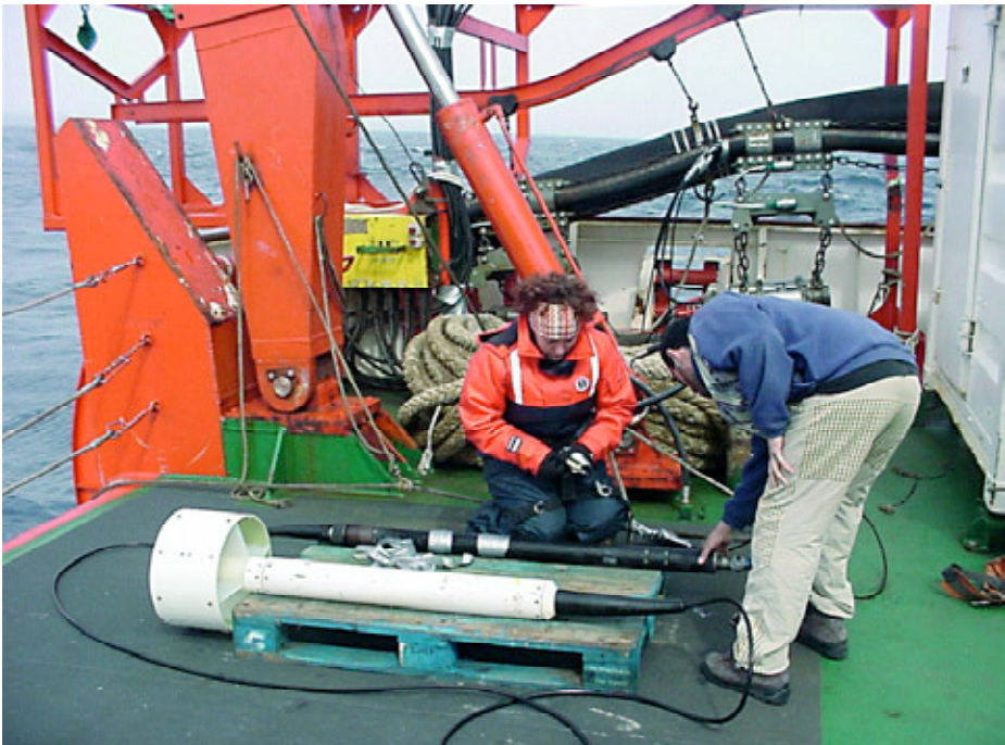
Preparando la maniobra de largado por la popa del magnetómetro marino.
