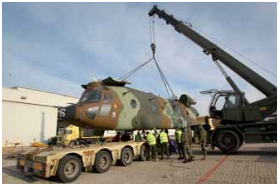
Especialistas de las FAMET desmontan las distintas partes del helicóptero. A la derecha, una grúa coloca el cuerpo de uno de los CH-47 sobre la góndola que lo transportó por carretera hasta la base aérea de Torrejón.
