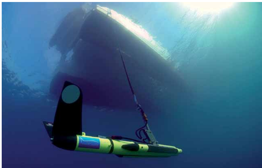
El sonar de barrido lateral Klein 3900 del Centro de Buceo de la Armada, lanzado desde la lancha Escandallo , realizó búsquedas hasta 40 metros de profundidad.
