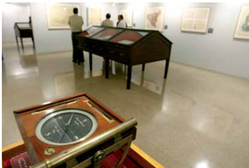
En el levantamiento de los itinerarios y de los campos atrincherados, esencia de la cartografía militar, se utilizó la brújula de caja para trazar los rumbos.
