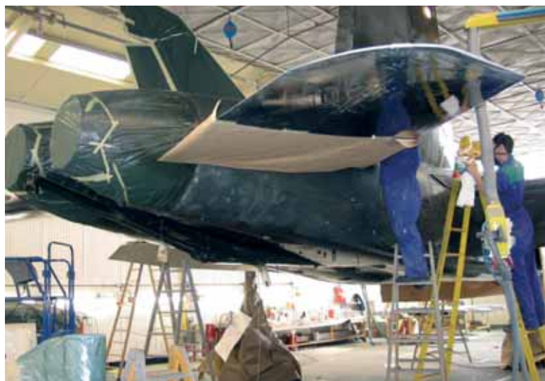
Debajo del acabado final de los aviones de combate como el F-18 existe otra de imprimación
