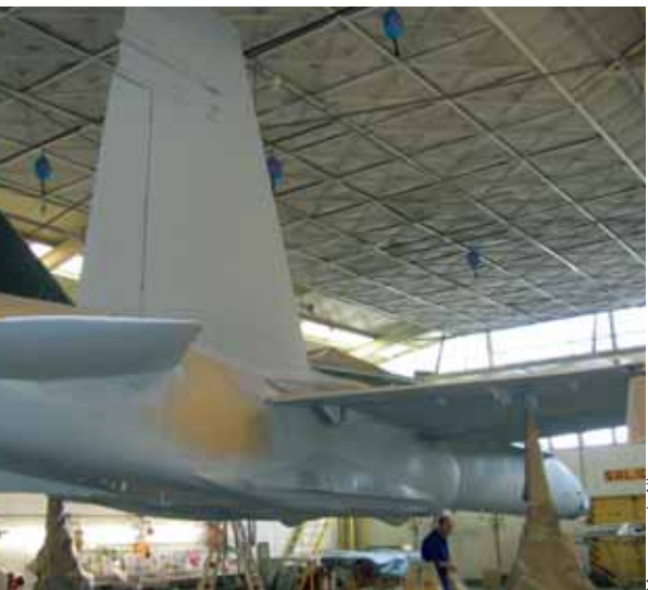
En aplicación sobre el fuselaje —una vez lijado el sustrato, foto izquierda— cuya función es proteger de la corrosión las partes externas de las aeronaves.
