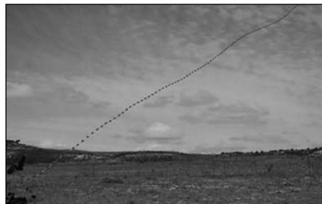
*Foto 4. Lanzamiento de manguera dragaminas ligera.*
