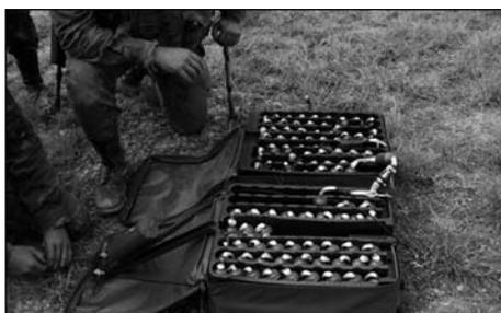
*Foto 3. Miembros de la UZAPAC 6 preparando para su lanzamiento una manguera dragaminas*
