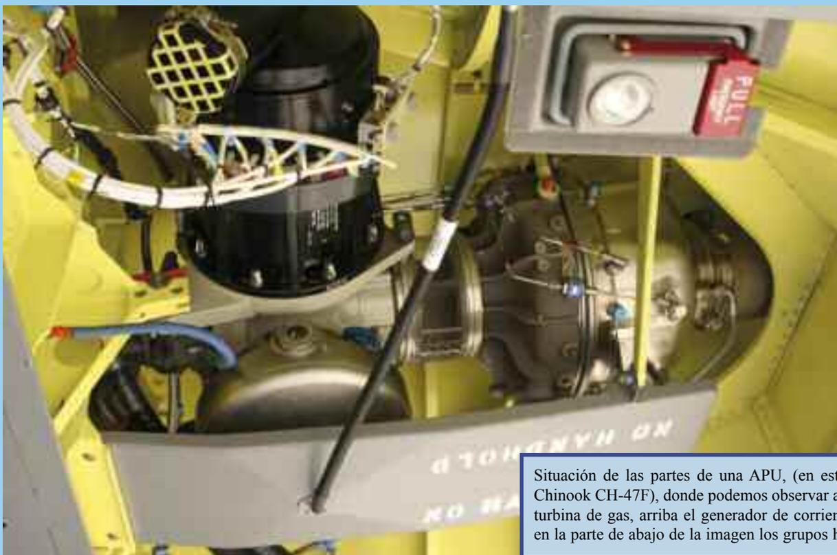
Situación de las partes de una APU, (en este caso en un Chinook CH-47F), donde podemos observar a la derecha la turbina de gas, arriba el generador de corriente eléctrica y en la parte de abajo de la imagen los grupos hidráulicos.
