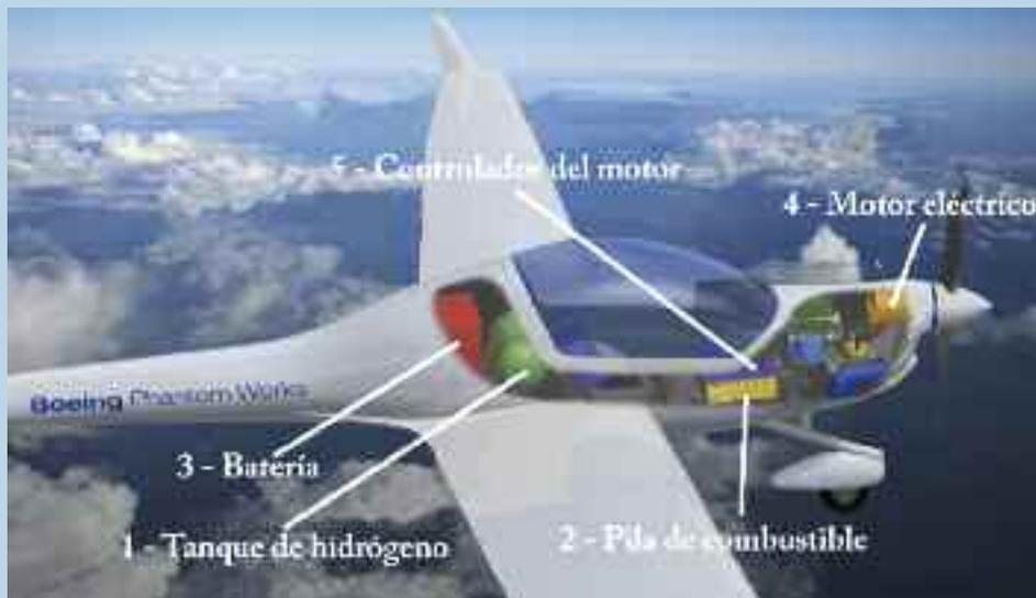
*Pila de combustible acoplada a un avión ligero o motovelero.*
