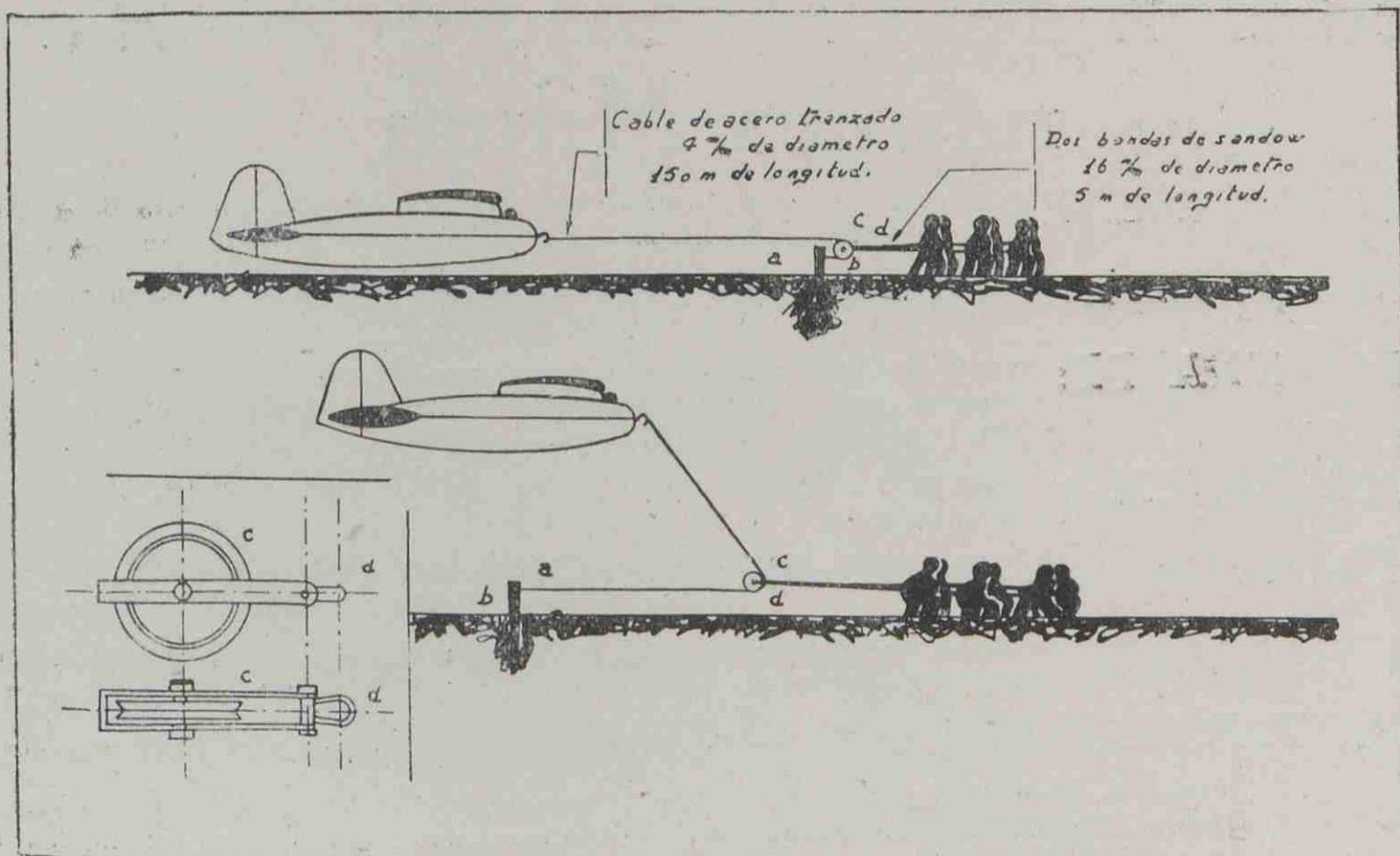
gancha en la proa del planeador; una garrucha unida a la bisectriz de dos bandas de sandow, de 16 mm. de diámetro y 5 m. de longitud, forma el codo de fuerzas, por cuya garrucha se pasa el cable de acero, y su otro extremo se sujeta a un jalón que se clava en el suelo a la distancia de la longitud del cable de acero hasta la proa del planeador (o sean 150 m. de la proa del aparato).
