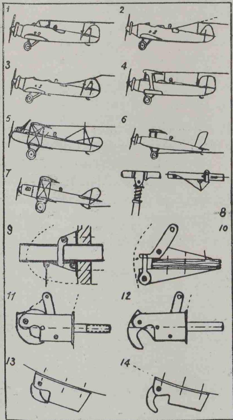
del cable de remolque debe estar comprendida entre 80 y 150 metros. Este cable está constituido por un hilo de acero de 3 mm. de diámetro, siendo de la mayor importancia que su enlace al planeador esté debidamente calculado para que en caso de sobrecarga pueda tenerse la certeza de que lo primero que se romperá será el cable.
