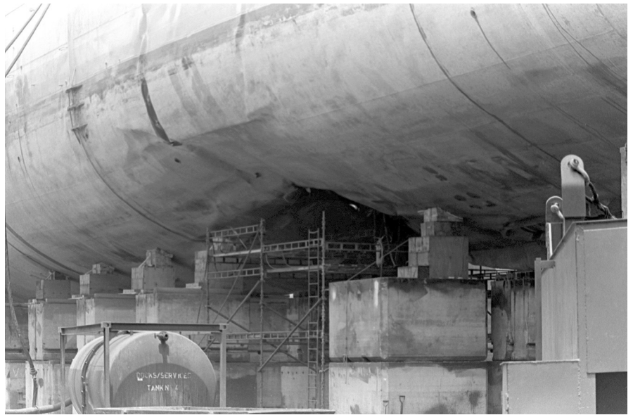
Fig. 5. Daño causado por una mina iraní el 14 de abril de 1988 en el Golfo Pérsico. (Fuente: U.S. Navy).
