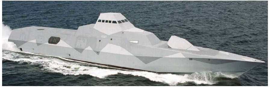
Fig. 1. Diseño de baja firma radar. (Fuente: Ver referencias).
