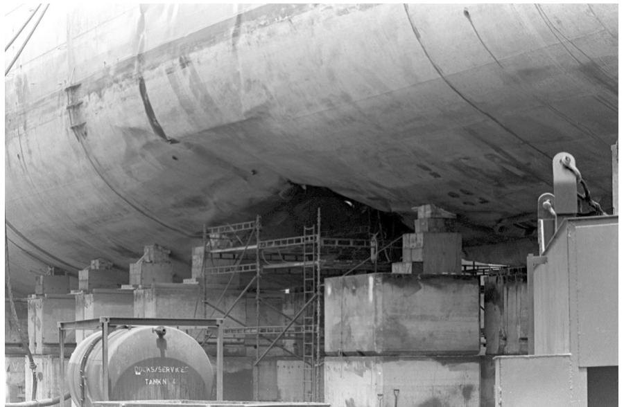
Fig. 5. Daño causado por una mina iraní el 14 de abril de 1988 en el Golfo Pérsico. (Fuente: U.S. Navy).
