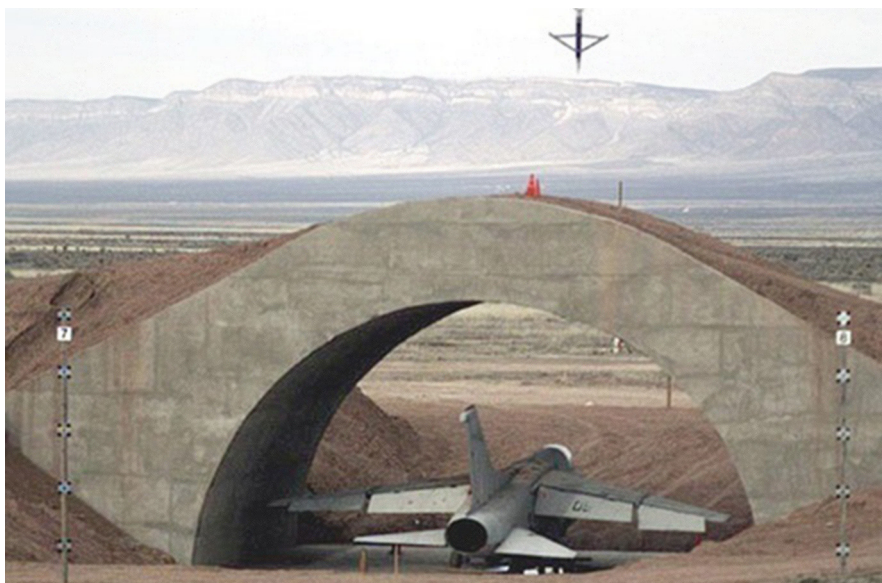
Fig. 2. Impacto de una bomba de pequeño diámetro o SDB (Small Diameter Bomb) GBU39/B en un refugio reforzado para aviones o HAS (Hardened Aircraft Shelter). (Fuente: www.ausairpower.net ).
