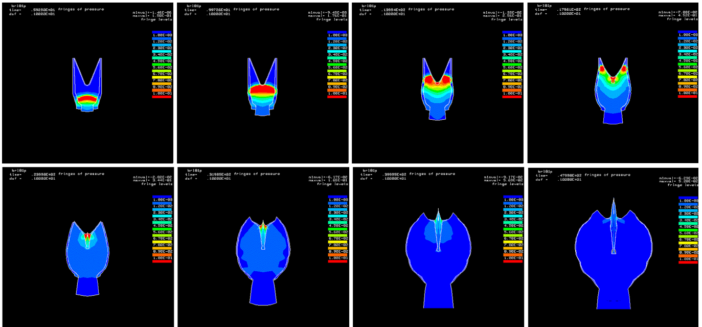
Fig. 5. Simulación del mecanismo explosivo de una carga hueca. Realizado a partir de un modelo fluidodinámico basado en elementos finitos (Fuente: Hydrossoft International).
