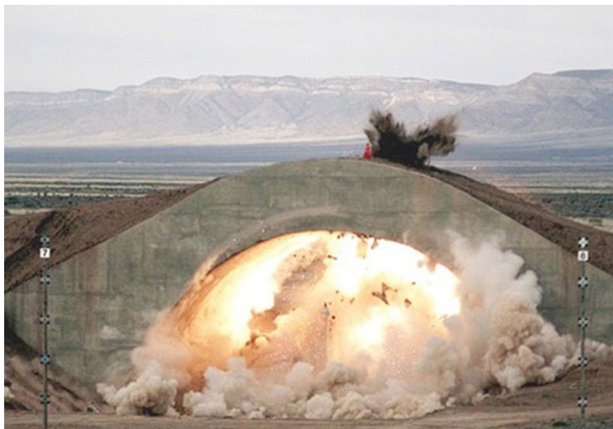
Fig. 3. Impacto de una bomba de pequeño diámetro o SDB (Small Diameter Bomb) GBU39/B en un refugio reforzado para aviones o HAS (Hardened Aircraft Shelter). (Fuente: www.ausairpower.net).
