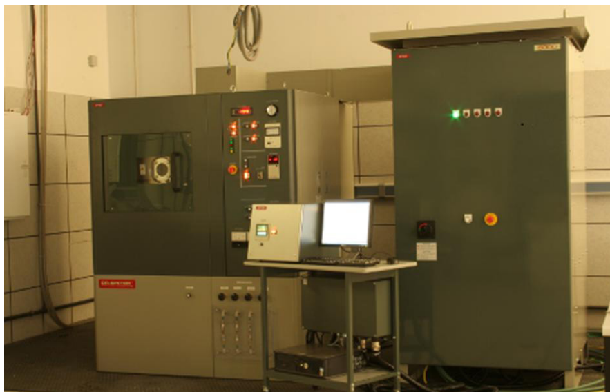
Fig. 4. Equipo de SPS del Instituto de Cerámica y Vidrio utilizado en este trabajo. (Fuente: González-Marcos, A.P. (coord.)).
