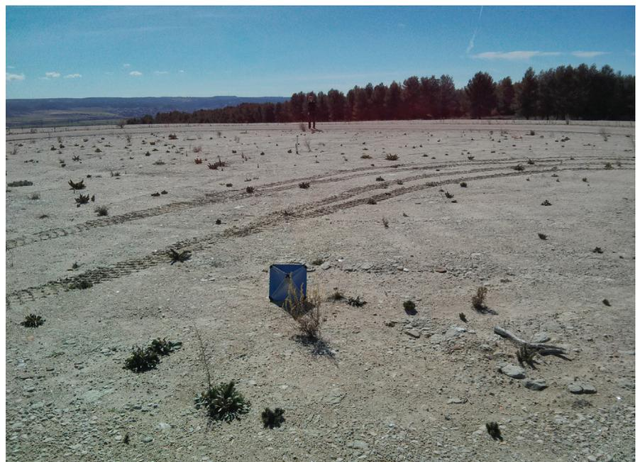
Fig. 4. Reflector tetraédrico en zona de bajo nivel de clutter en el ITM. Procedimiento de calibración del sensor. (Fuente: Advanced Radar Technologies S.A)
