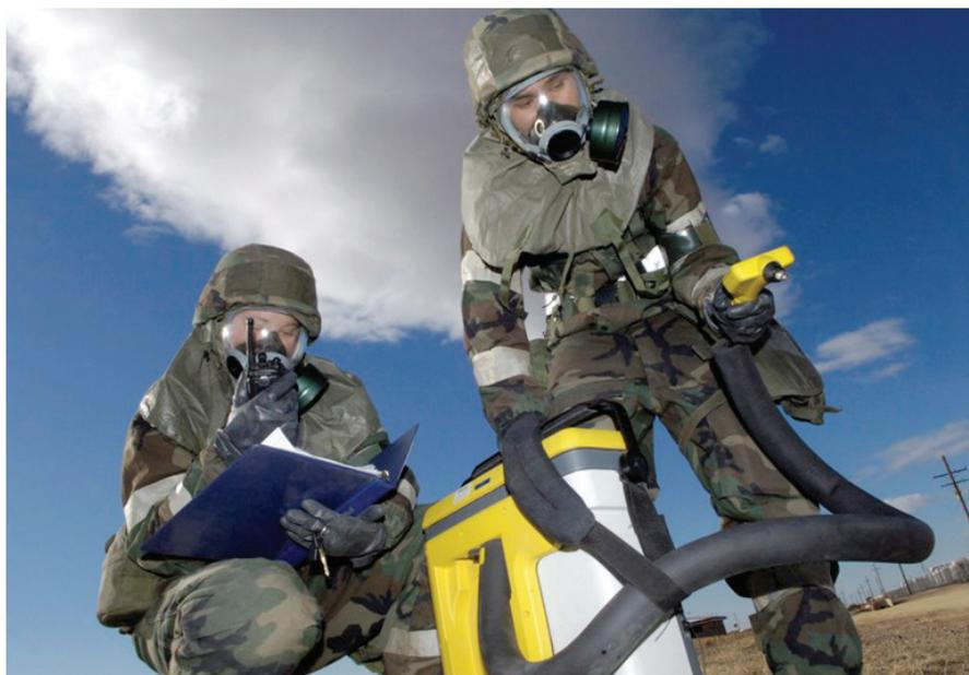
Fig. 1. Espectrómetro de masas acoplado a un cromatógrafo de gases para uso en campo. (Fuente: INFICON).
