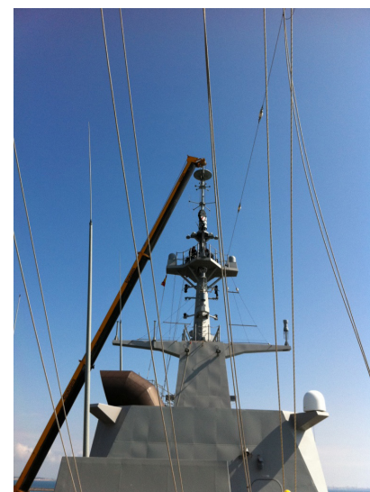
Fig. 4. Maniobra de izado de las antenas del subsistema ECM en el buque LHD "Juan Carlos I".
