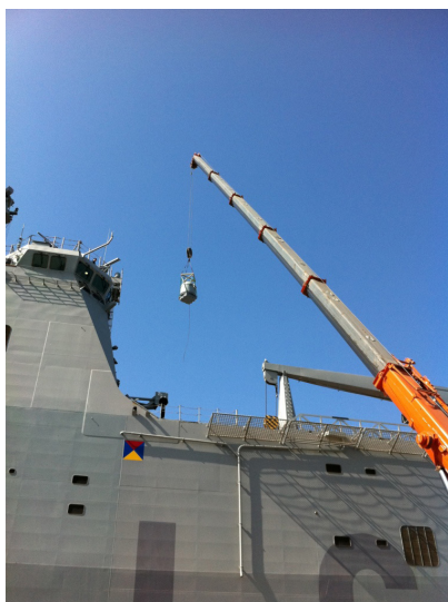
Fig. 2. Instalación de una de las antenas del subsistema ECM en el buque LHD "Juan Carlos I".
