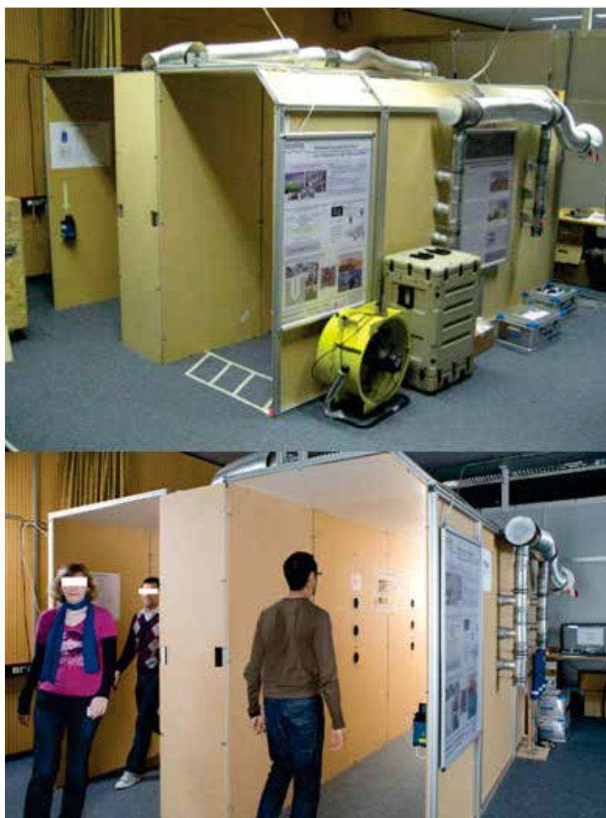
Fig. 3. Sólo mediante el uso de algoritmos avanzados de fusión sensorial puede aprovecharse plenamente la capacidad de ciertos sensores para la identificación de amenazas. En la imagen, sistema experimental HAMLeT (Hazardous Material Localization and Person Tracking) para la detección de terroristas con armas químicas. (Fuente: Instituto Fraunhofer FKIE).
