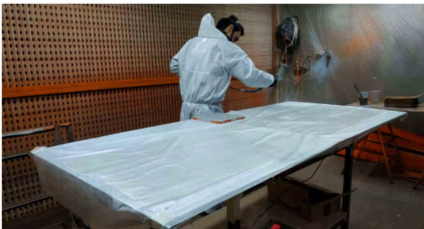
Fig. 3. Aplicación de pintura de baja observabilidad sobre una superficie. (Fuente: Micromag)
