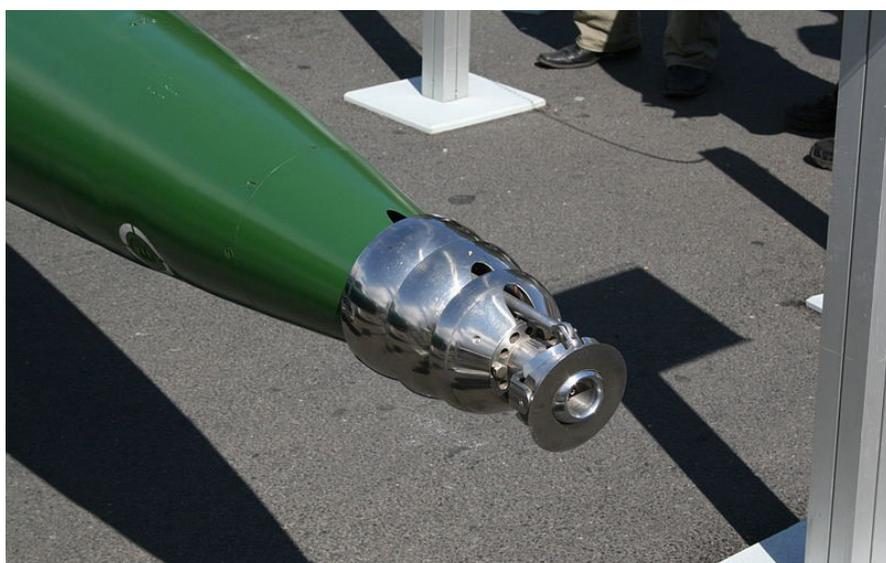
Figura 5. Cabeza del torpedo ruso supercavitante VA-111 Shkval. Fuente Wikimedia
