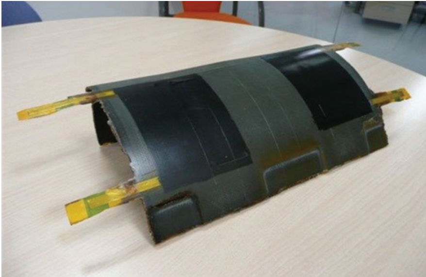
Fig. 2. Se han obtenido compuestos con films de grafeno embebidos en resina epoxi. (Fuente: Tecnalia)
