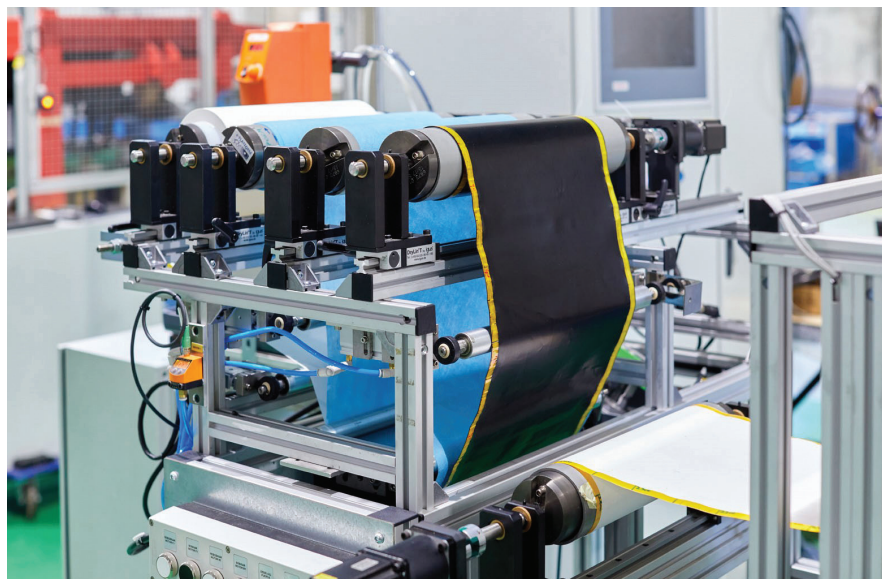
Fig. 3. Planta piloto para la fabricación de laminados. (Fuente: Tecnalia)
