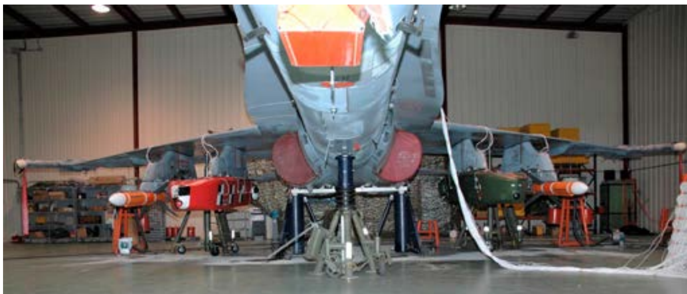
Figura 2. GVT de EF-18 realizada en el CLAEX. (Fuente: Revista Aeronáutica y Astronáutica n.º 855.)
