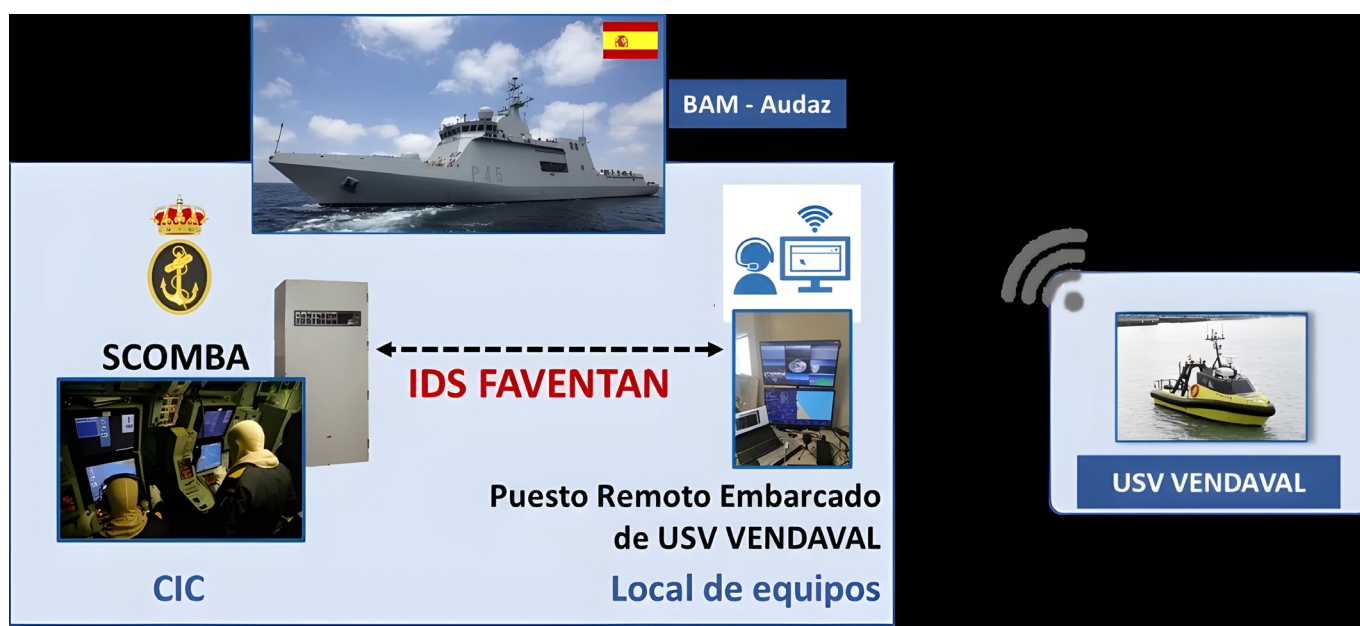
Figura 4. Pruebas de integración de USV con SCOMBA en entorno real (fuente: Navantia)
