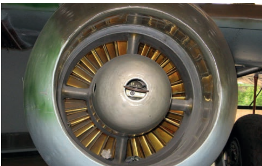
Vista frontal del Jumo 004, en donde se aprecia el tirador de la unidad de arranque, un motor de motocicleta Riedel, en la admisión (Imagen: Distractreact)
