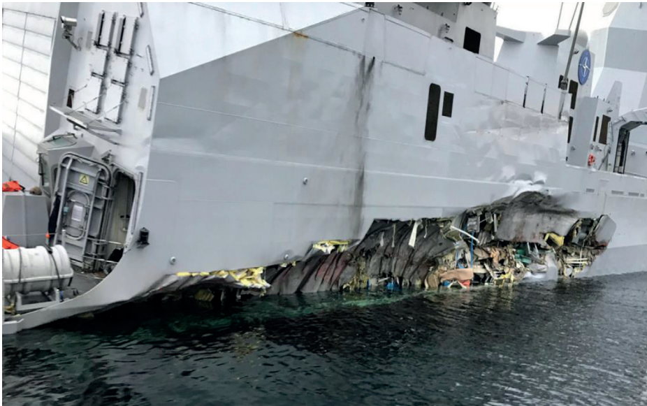
Figura 6. Vista de los daños en el costado de estribor de la fragata Helge Ingstad. (Fuente Wikipedia)
