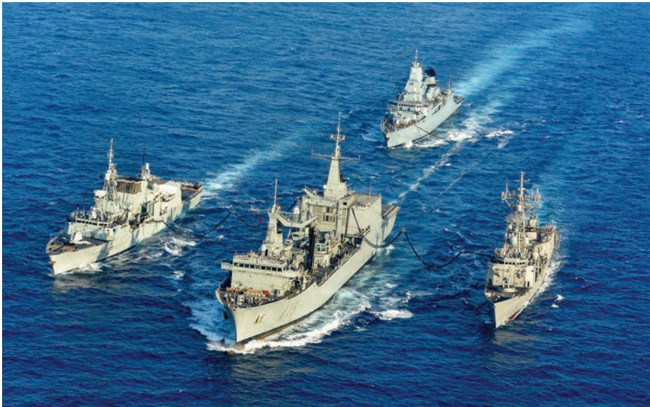
BAC Cantabria dando suministro simultáneo de combustible a tres buques. (Foto: Armada)
