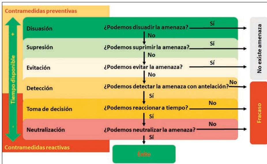
Propuesta de flujoograma para el análisis de incidentes con drones. (Elaboración propia)
