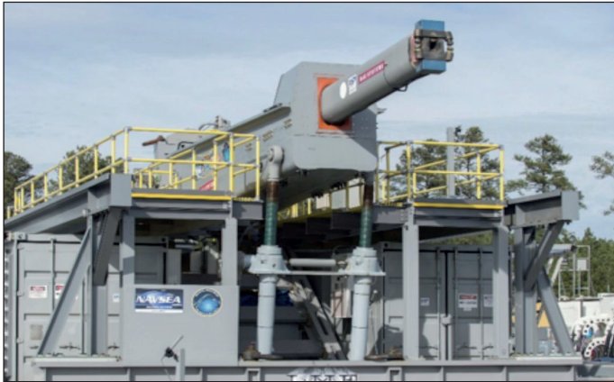
Cañón de riel electromagnético. (Fotografía US Navy)
